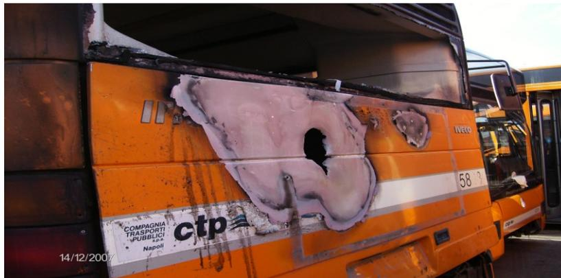
Figura 9.3: Foratura portellone motore a seguito dell'incendio.
