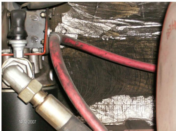
Figura 9.16: Danneggiamento paratia a causa di impatti e manipolazioni.
