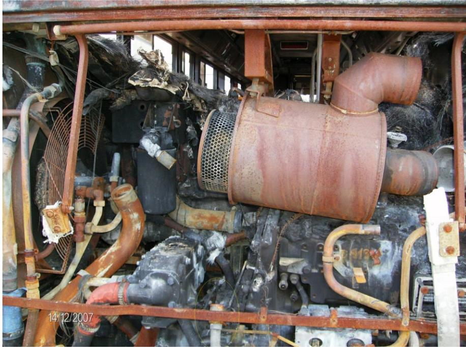
Figura 9.7: Danni al vano motore: parte sinistra, veicolo parzialmente incendiato.
