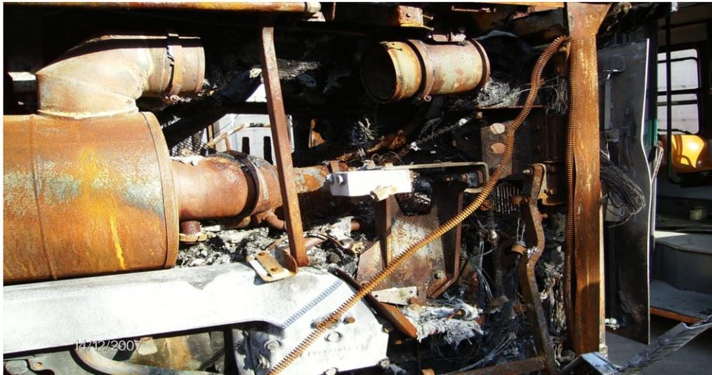
Figura 9.12: Danni al vano motore: parte destra, veicolo totalmente incendiato.
