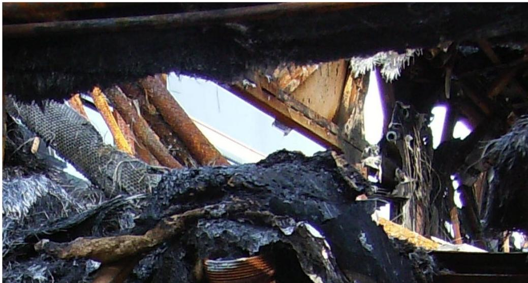
Figura 9.15: Danneggiamento paratia d'isolamento del vano motore in seguito ad incendio.
