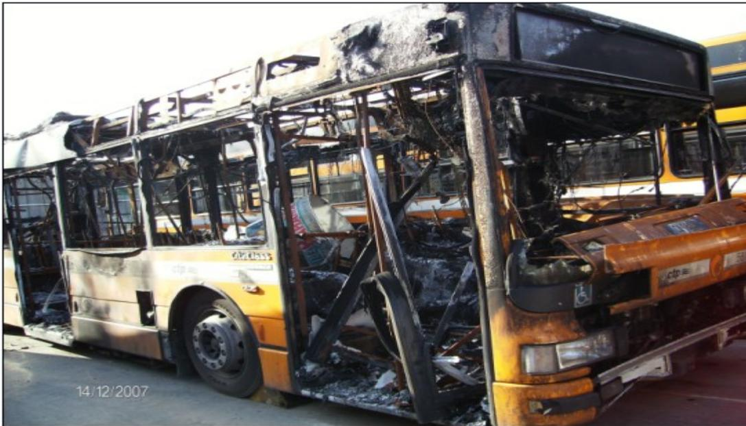
Figura 9.1: Rivestimento esterno autobus totalmente incendiati.
