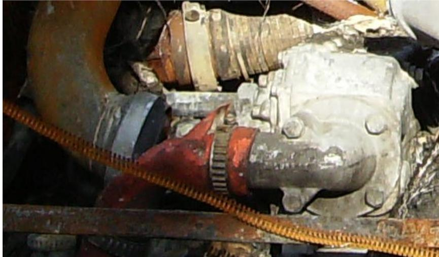
Figura 9.10: Scambiatore di calore, autobus incendiato.
