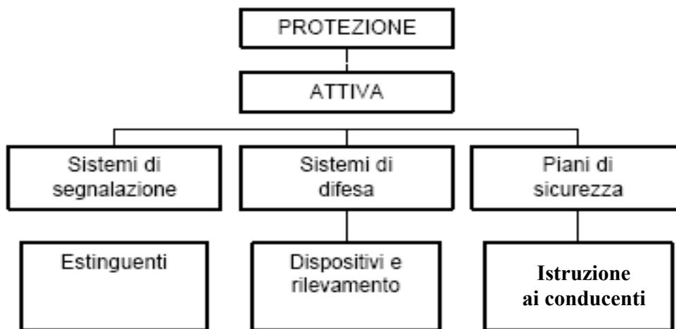
Figura 6.4: Le misure di Protezione Antincendio Attive.
