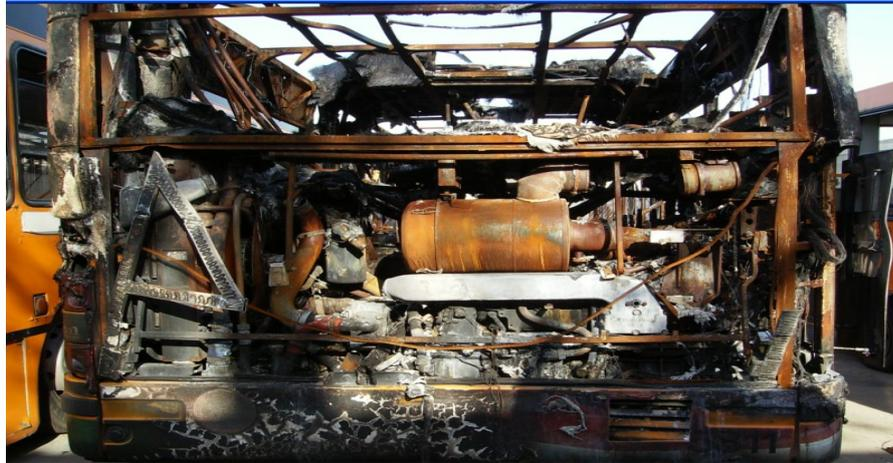
Figura 9.2: Parte posteriore autobus totalmente incendiato.
