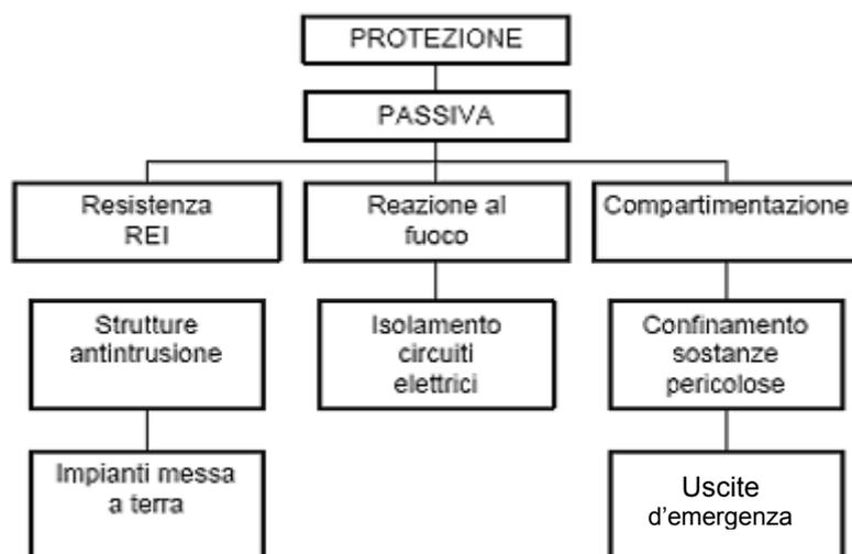
Figura 6.5: Le misure di Protezione Passiva Antincendio.
