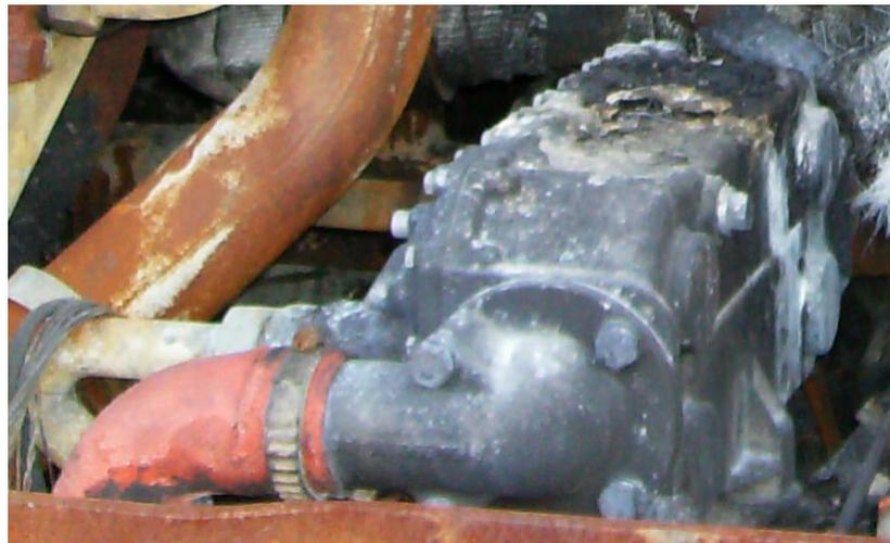
Figura 9.11: Scambiatore di calore autobus parzialmente incendiato.
