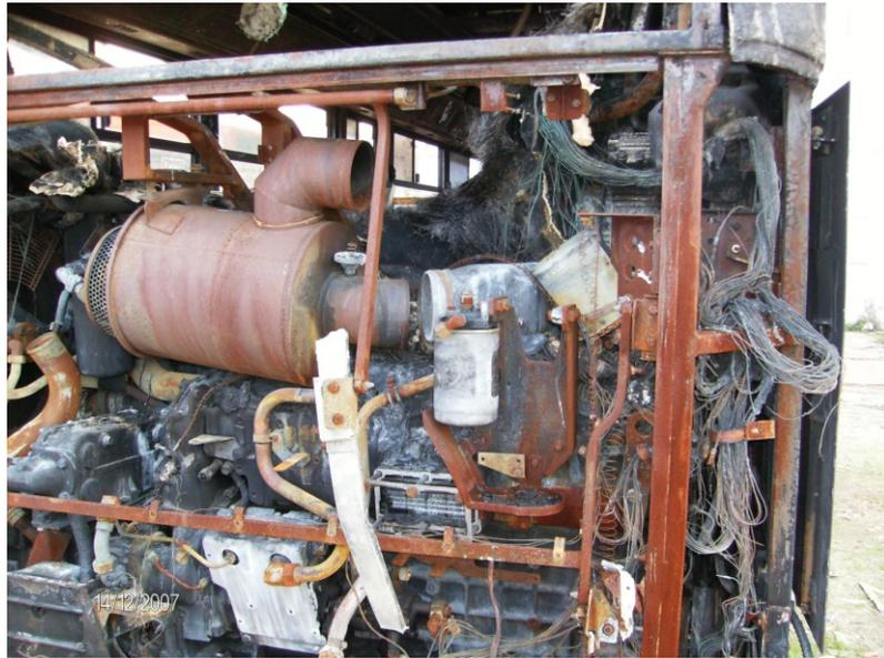
Figura 9.13: Danni al vano motore: parte destra, veicolo parzialmente incendiato.
