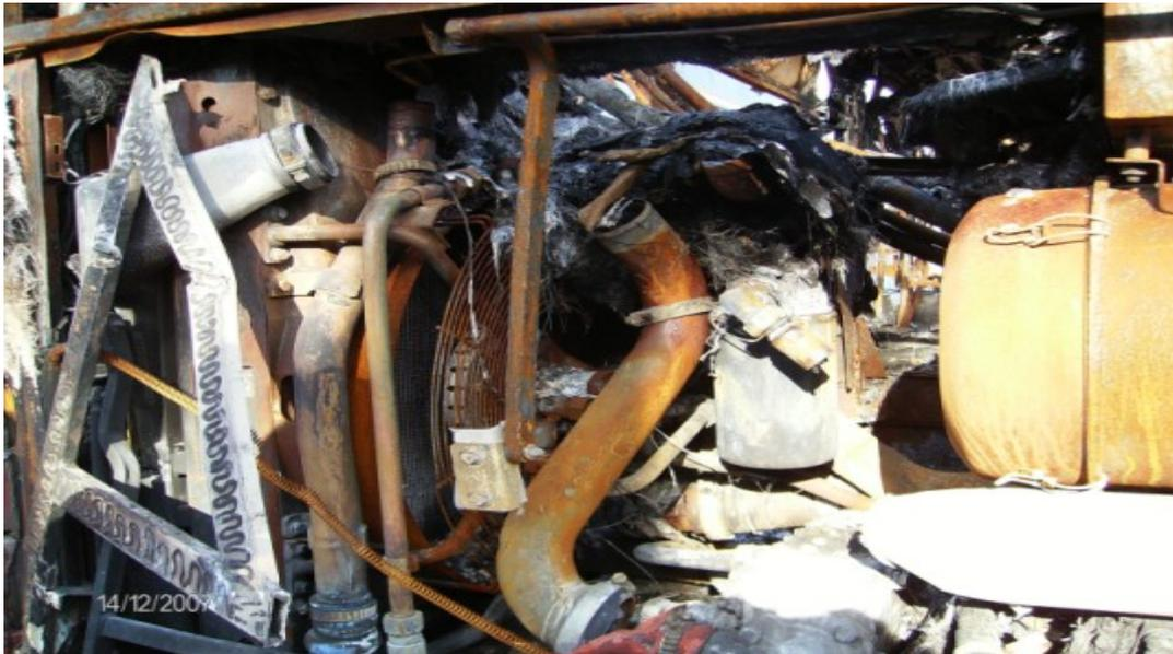
Figura 9.6: Danni al vano motore: parte sinistra, veicolo totalmente incendiato.
