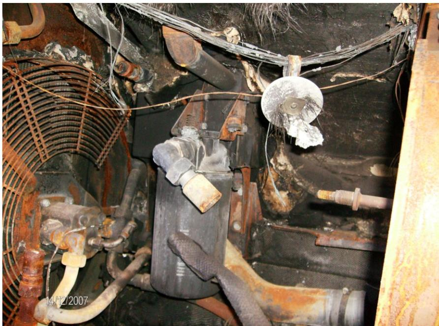
Figura 9.8: Danni al vano motore: parte sinistra, veicolo parzialmente incendiato.
