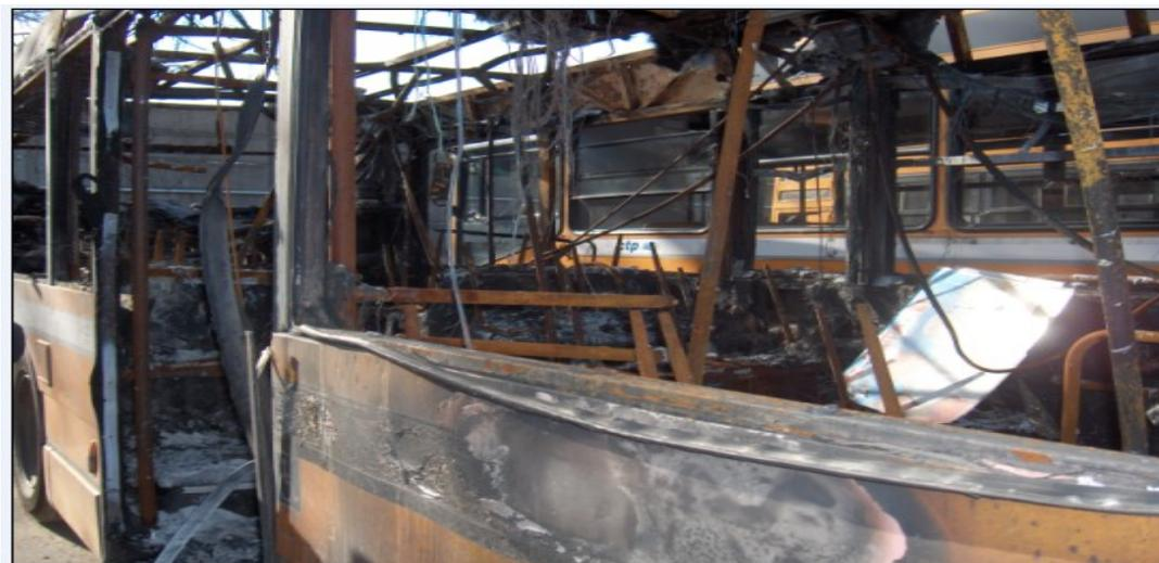
*Figura 7.1: Autobus completamente distrutto da un incendio.*
