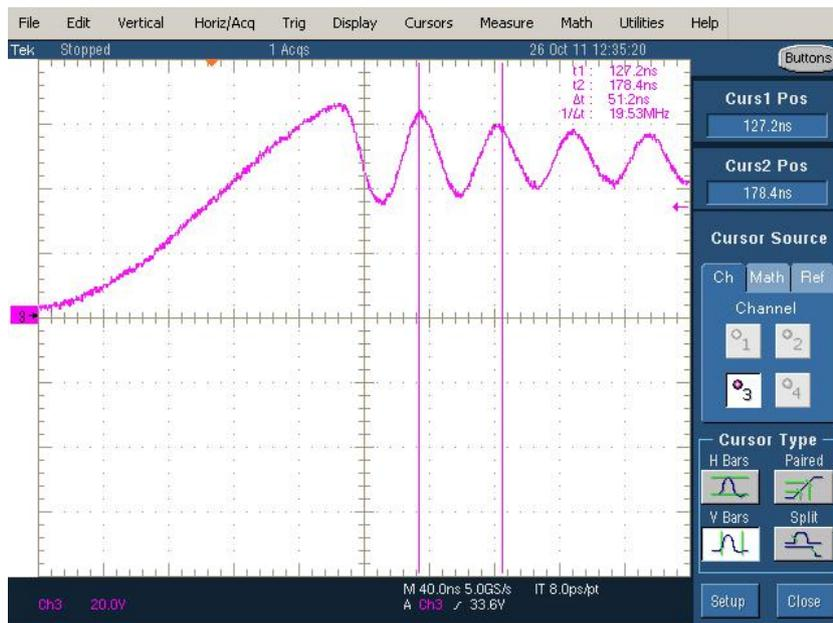
Figura 6.15: Particolare delle oscillazioni nella tensione tra drain e source del Mosfet all'apertura.
