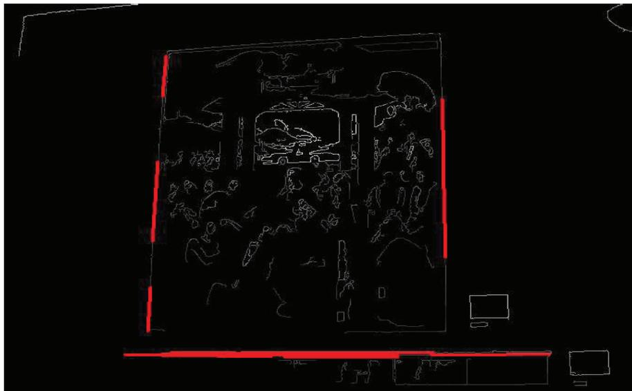
Figura 15: applicazione della trasformata di hough per la ricerca di rette sul quadro di figura 14.
