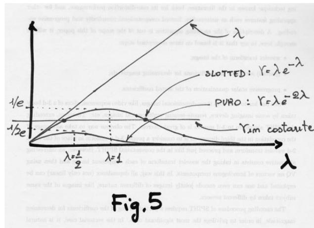
Per quanto riguarda l'analisi dinamica (vedi Fig.5), la situazione non è cambiata rispetto al caso dell'ALOHA puro se non per l'aumento del throughput: abbiamo ancora due punti di equilibrio, stabile il primo, instabile il secondo, per cui il sistema è sempre tendenzialmente instabile. Come già detto, però, questo risultato discende dalle ipotesi pessimistiche fatte, e l'analisi più accurata fatta qui di seguito rivela come la situazione sia in realtà meno critica.
