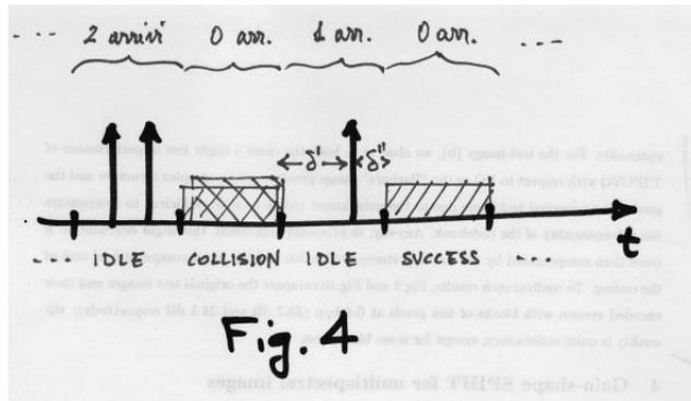
In questa situazione, la frame che tentiamo di trasmettere andrà incontro ad una collisione solo se nello stesso slot in cui essa arriva c'è almeno un'altro arrivo. Detto  $\delta'$  l'intervallo fra inizio slot e arrivo della frame e  $\delta''$  l'intervallo fra arrivo della frame e fine slot, in analogia a quanto fatto prima possiamo scrivere
