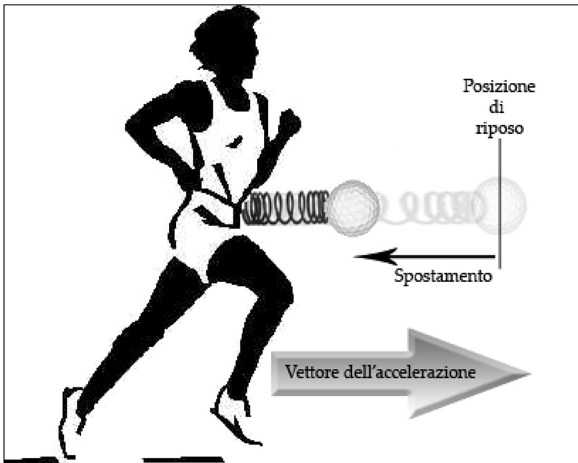
La massa quindi si sposta dalla propria posizione di riposo in modo proporzionale all'accelerazione rilevata. Un sensore trasforma questo spostamento in un segnale elettrico acquisibile dai moderni sistemi di misura.
