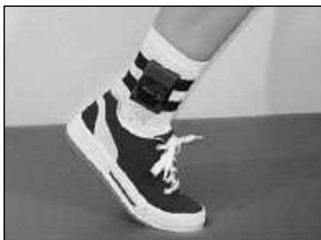
**Figura 3** Accelerometro posizionato alla caviglia.
