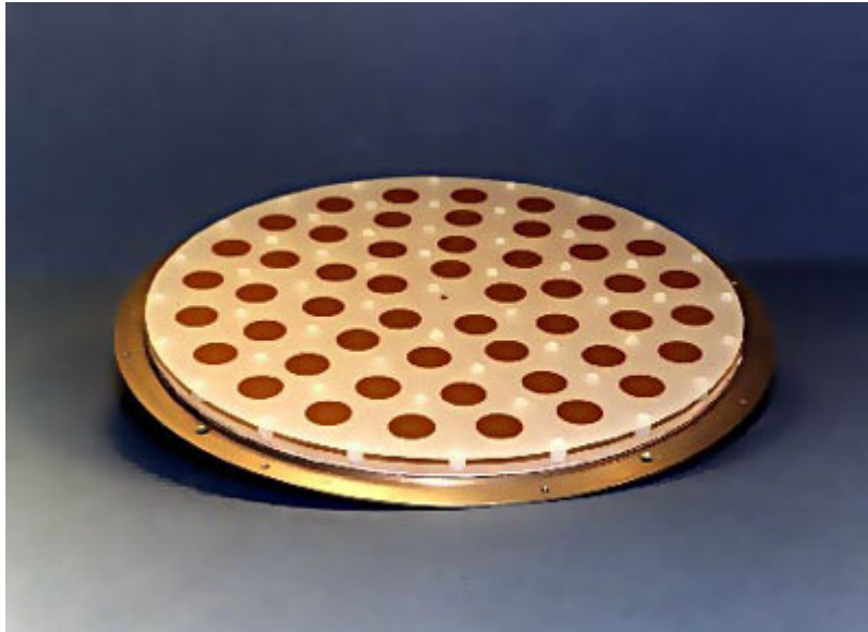
Figura 1.3: Array formato da cinquanta patch circolari.
