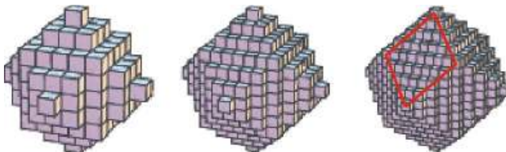
Fig. 2. Illustrazione (modificata da Haüy, Traité de minéralogie, 1801 ) di come il dodecaedro con facce rombiche sia costruito per progressivo decremento di una fila di ‘molecole’ su ciascuno spigolo delle lamelle successivamente disposte attorno ad un nucleo cubico.
